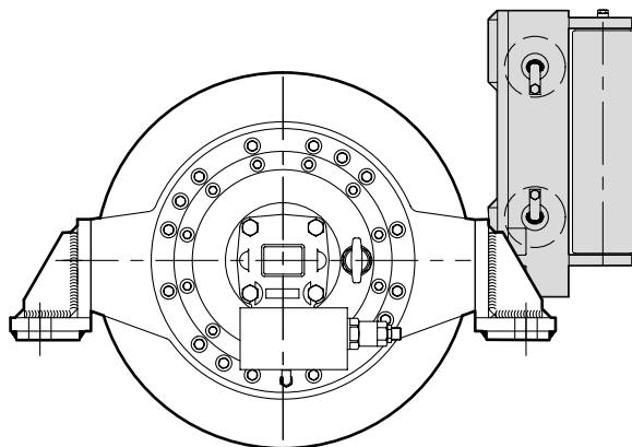
Realizzato in carpenteria saldata con rulli in acciaio orizzontali e verticali montati su boccole autolubrificanti.
