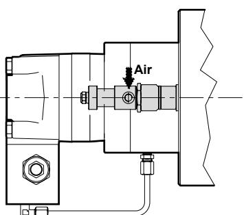
Il disinneso del tamburo di tipo pneumatico rende indipendente la rotazione del tamburo permettendo lo svolgimento manuale della fune.
