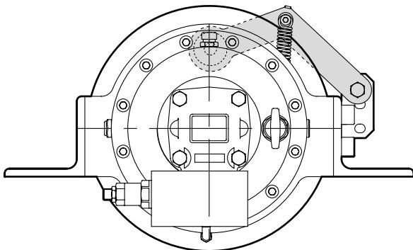
Realizzato in rullo d'acciaio su boccole autolubrificanti, favorisce un migliore avvolgimento della fune quando non è applicato il carico.
