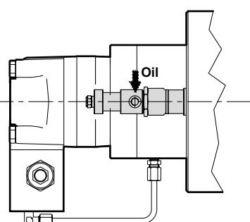
Il disinneso del tamburo di tipo Idraulico rende indipendente la rotazione del tamburo permettendo lo svolgimento manuale della fune.
