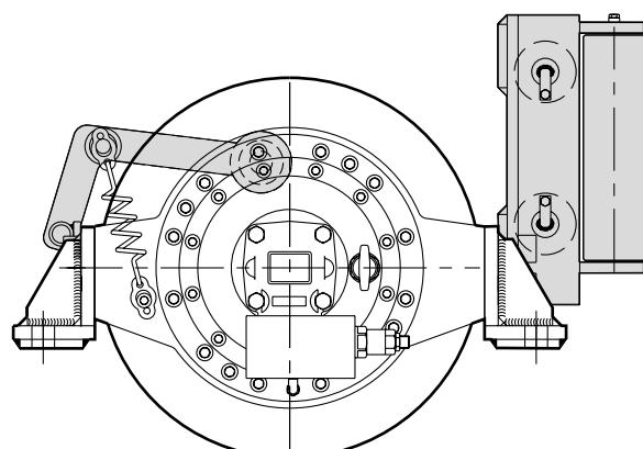
Il pressacavo è realizzato in rullo d'acciaio su boccole autolubrificanti, favorisce un migliore avvolgimento della fune quando non è applicato il carico. Il guidafune è realizzato in carpenteria saldata con rulli in acciaio orizzontali e verticali montati su boccole autolubrificanti.
