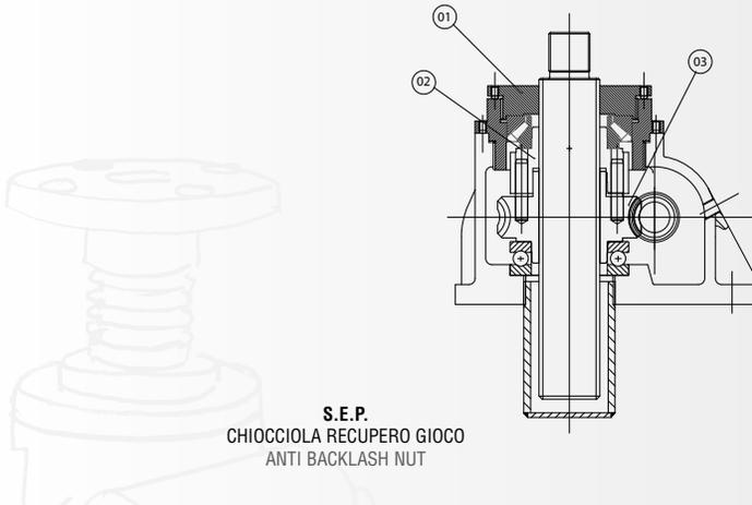
3.7.4 GUARNIZIONI: i martinetti (solo S.E.L.) prevedono l'utilizzo di O-ring e V-seal sulle ghiera superiore (Fig. 1-03) e tappo inferiore (Fig. 1-14) e anelli di tenuta sulla vite senza fine (Fig. 1-17) (S.E.L. - S.E.P.); al fine di evitare trafileamenti di lubrificante e/o ingresso di impurità all'interno dello stesso provvedere alla verifica ed eventuale sostituzione come da tabella di manutenzione programmata.
